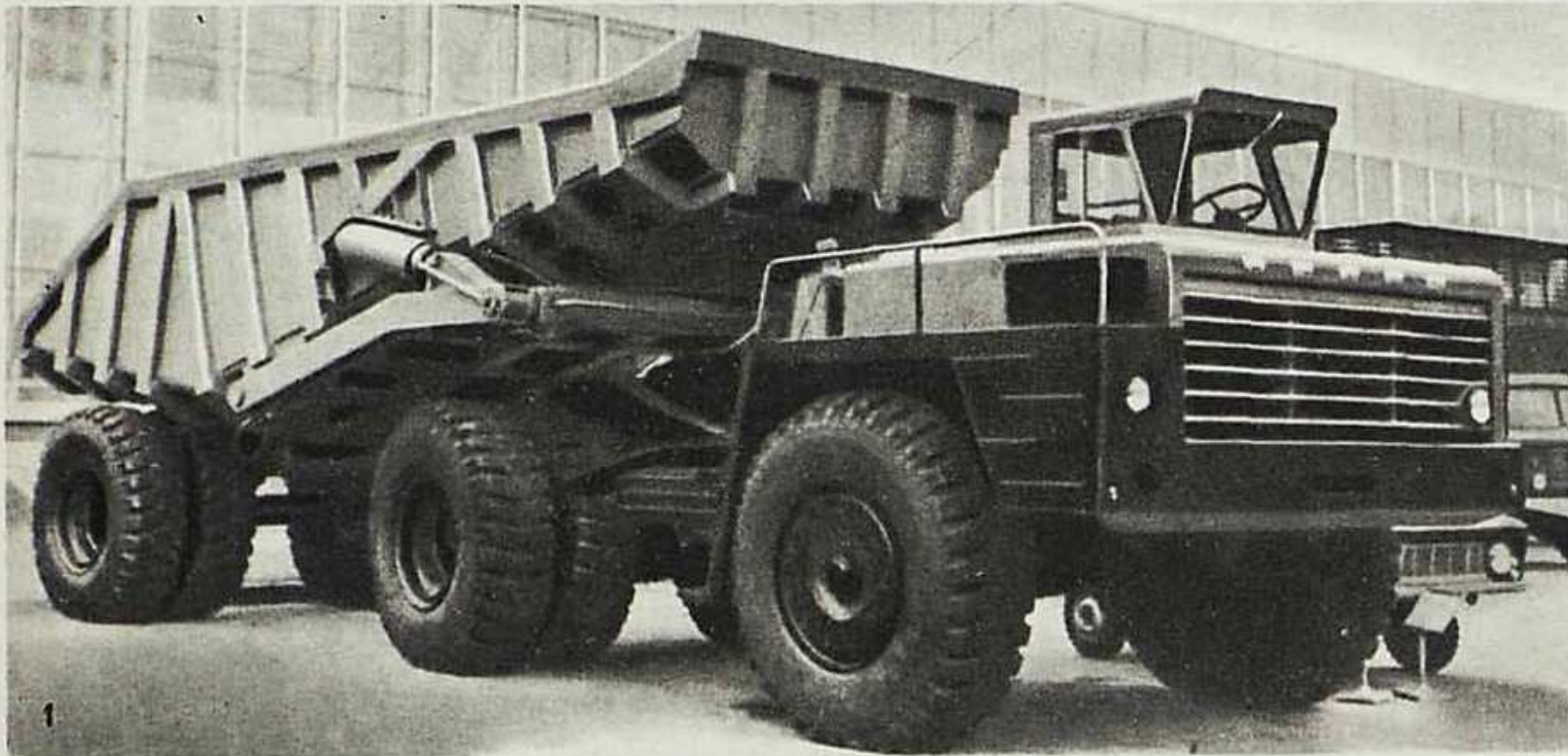
1. БелАЗ-548В с самосвальным полуприцепом. 65 тонн поднимает этот богатырь! Горная и строительная техника получила надежного помощника.
